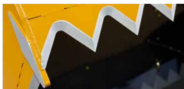
Navařovaný břit z materiálu Hardox 500.
